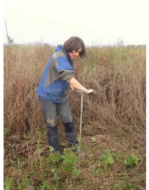
Peilbuizen slaan tot 2,5 – 3 m diepte
